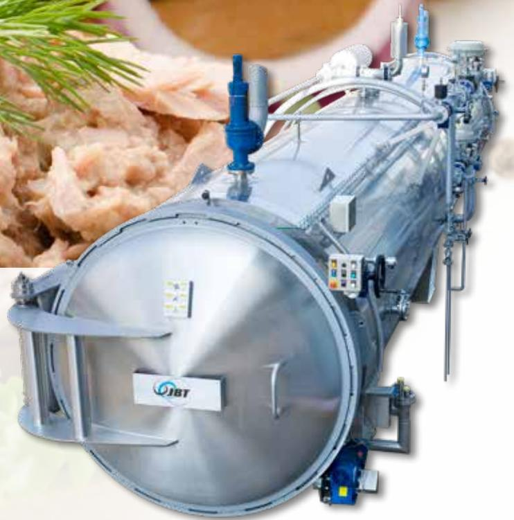
Si está buscando procesar atún de manera eficiente, consulte nuestro Pre-Cocedor - Enfriador de Atún en vacío. Lo diseñamos para descongelar y cocer atún en vacío y enfriarlo con eyectores de vapor.
