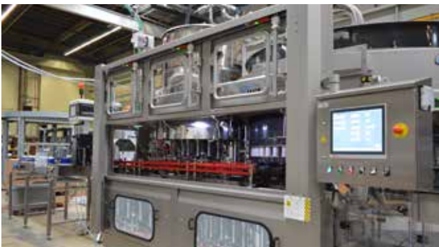
La puerta lateral automática facilita el acceso a la entrada y a la taponadora de Ultra Clean Precifill™
