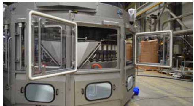
Las puertas laterales, con bloqueo mecánico y eléctrico, facilitan el acceso a la zona de llenado de la Ultra Clean Precifill™
