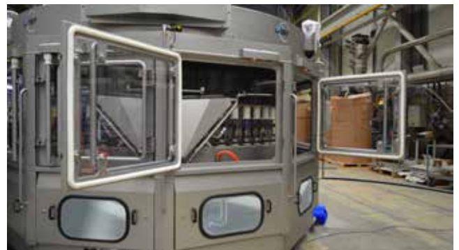
Mechanisch und elektrisch verriegelte Seitentüren für leichten Zugang zum Füllbereich eines Ultra Clean Precifill™
