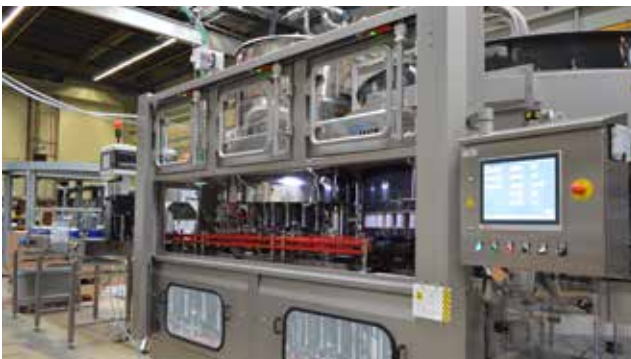
Eine automatische Seitentür für leichten Zugang zur Einlauf- und Verschleißeinheit Ultra Clean Precifill™
