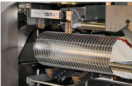
Los separadores de red garantizan una distribución uniforme y consistente de las redes por pieza de producto para un rendimiento óptimo del envasado en redes.
