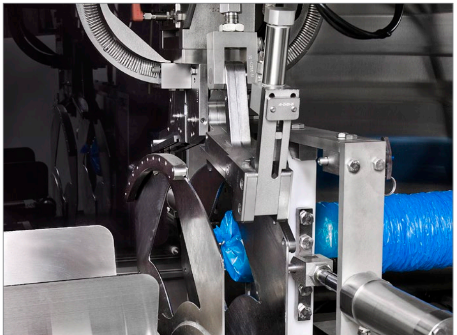
Máquina clipeadora resistente de la serie RS y conjunto divisor para un cierre por clip consistente y seguro.
