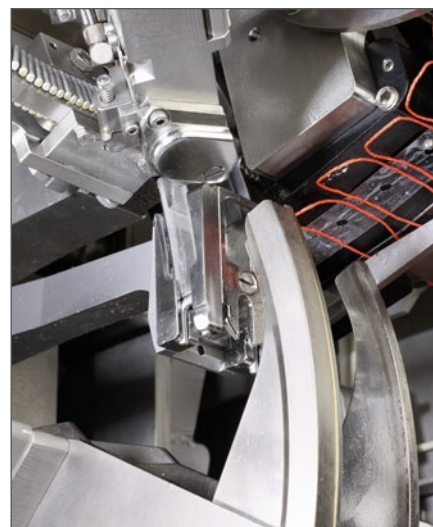
Техника Shuttle-Clip: Вытеснение и клипсование – высокая точность, быстрота, соответствие калибру и бережное обращение с оболочкой.
