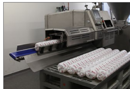
Конфигурация с боковой выгрузкой для работы в ограниченном пространстве
