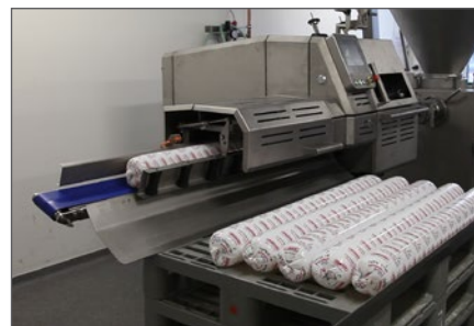
Configuração de descarga lateral para os casos em que o espaço é limitado
