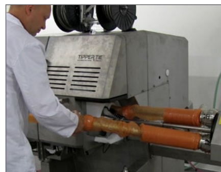
O revólver rotativo opcional permite a troca da tripa praticamente sem tempos de imobilização
