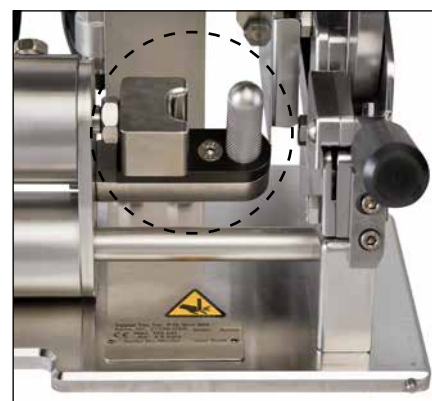
El diseño ergonómico reduce el esfuerzo invertido por el operario, y lo hace mediante un dispositivo de apriete de cilindro moleteado, el cual sujeta firmemente la tripa para empujar el producto.
