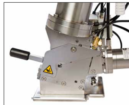
Las tijeras separadoras permiten la entrada sencilla del producto y una subdivisión excelente del material de las tripas y de las redes.
