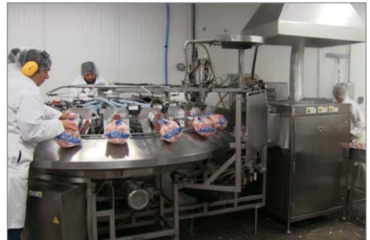
Der Rota-Matic integriert sich leicht in bestehende Verpackungssysteme für eine kontinuierliche Hochgeschwindigkeits-Vakuumpackung.
