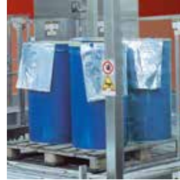
Enchimento de tambores
