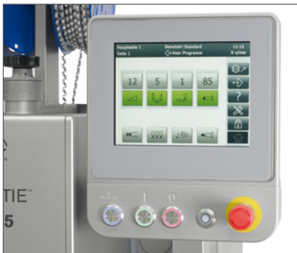
Управление автоматами для двойной заклип-совки ТТ производится с сенсорного экрана
