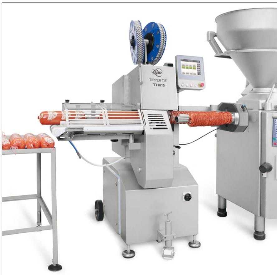
dable. Le refoulement de l'expansion a lieu au moyen d'une came fermée. Le galet de came est guidé aussi bien à l'ouverture qu'à la fermeture. Le mouvement du levier de fermeture du clip a lieu au moyen de cames à bourrelet. Ces solutions constructives confèrent aux double clippeuses automatiques TT une durabilité élevée alors que l'usure est minimale.
