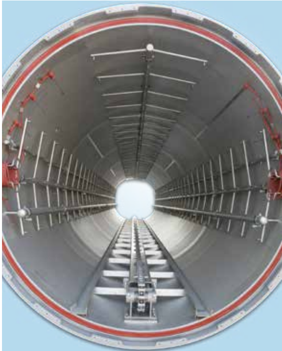
Rociadores laterales para enfriado del pescado y colectores con rociadores para enfriado del autoclave
