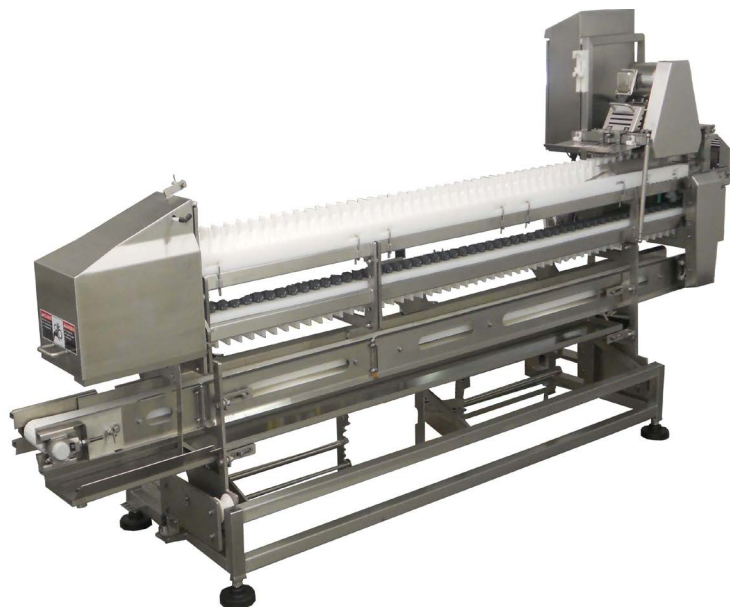
CWS-1-RB Navalha Rotativa com 90" área de limentação
