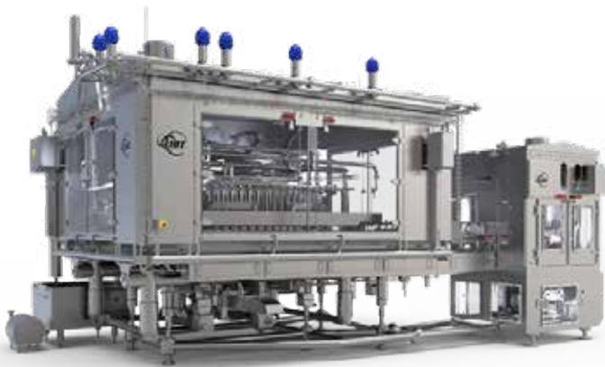
Unifiller de alta capacidad con 81 estaciones de envase, sincronizado con el sellador X-59. Esta configuración está diseñada para hacer funcionar latas a una velocidad de línea de hasta 1500 latas por minuto.
