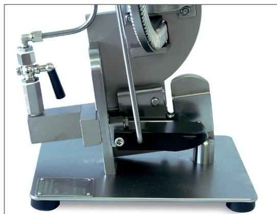
**Actionnement à levier palpeur et couteau de sectionnement blocable.**
